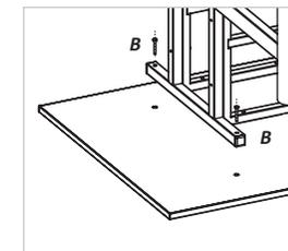
2.2 Posicione os bancos e fixe utilizando os parafusos M6X12, em seguida posicione o tampo e fixe utilizando os parafusos M6X40.
